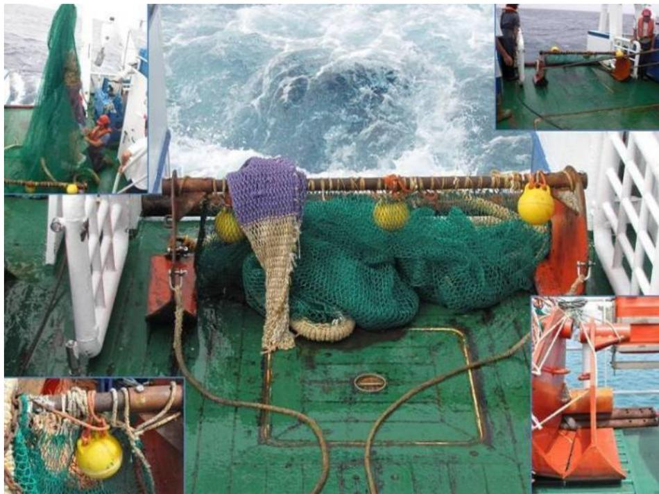
**Figura 4.4.5.** Bou de vara en cubierta y detalles de sus partes y las maniobras con él.
