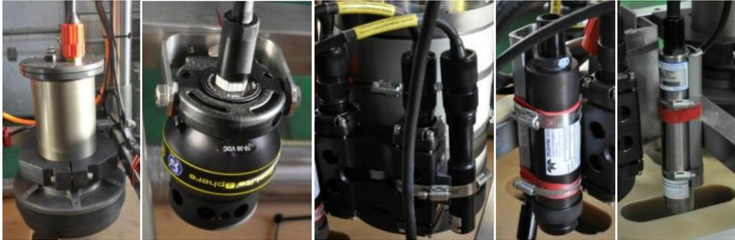
**Figura 4.4.15.** De izquierda a derecha, flash submarino, leds, lasers, altímetro y sensor de presión.
