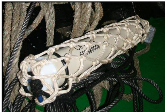
El C-POD registra el tiempo de ocurrencia, la frecuencia central, la intensidad, la duración, el ancho de banda y la tendencia de la frecuencia de los clicks tonales, dentro del rango que va desde los 20 kHz hasta los 150 kHz. Esto le permite monitorizar clicks de todas las especies de cetáceos odontocetos a excepción de los cachalotes.
