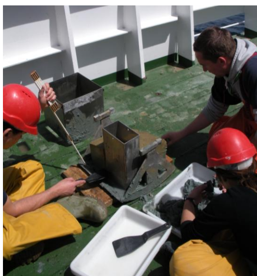
Figura 11. División de la columna de sedimentos obtenida con la draga Box Corer en estratos de 5 cm de espesor para el muestreo biológico. Se observa el cajetín metálico de menor tamaño para extraer una muestra para el análisis sedimentológico.
