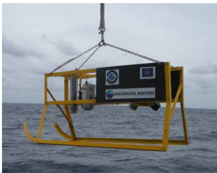
Figura 5. Vehículo de observación remolcado, donde se aprecia el pinger, a proa, y la carcasa donde va alojada la cámara de fotos, justo detrás. Bajo los paneles rotulados se observan el tubo de la cámara de video y el foco correspondiente.
