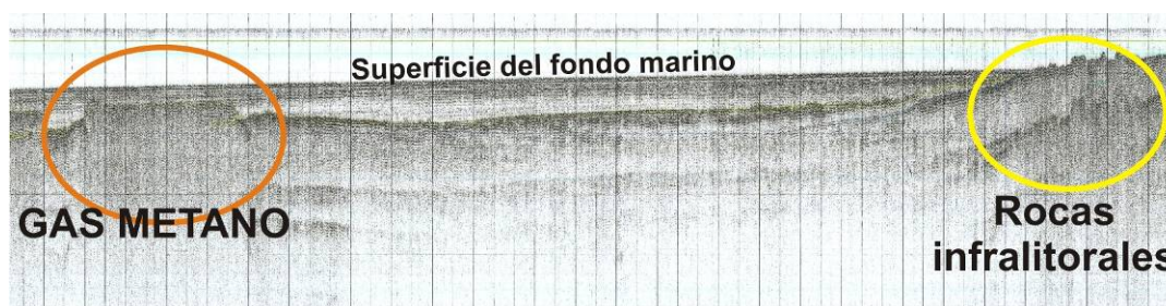
Figura 2. Sección sísmica obtenida con un geopulse en la que se observan los dos dominios principales en la zona infralitoral distal y plataforma interna frente a Chipiona. Las rocas aflorantes representan los afloramientos pliocenos de la conocida roca ostionera, mientras que las unidades semitransparentes representan los depósitos del río Guadalquivir con intercalaciones de apantallamientos debidos a las concentraciones de gas interestratificadas.
