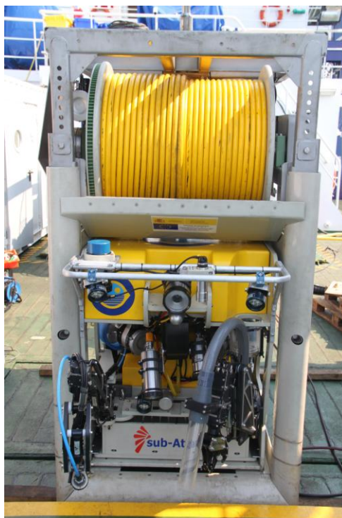
Figura 9: Vehículo de Operación Remota Liropus 2000 dispuesto dentro del TMS. El rollo de cable de color amarillo es el cable de excursión, y se observan los focos de iluminación, las cámaras de vídeo y los brazos manipuladores. En la base se dispone la bandeja de muestras.
