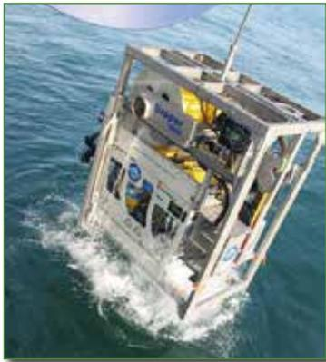
**Figura 3.11.** ROV: vehículo operado a distancia (*Remote Operated Vehicle*, ROV): es un sistema de observación submarina no tripulado y operado desde superficie. Puede interactuar con el fondo marino al disponer de brazos articulados. Está equipado con varias cámaras de video digital de muy alta resolución. No está equipado con cámaras fotográficas. **Fotos:** IEO/GEMAR.
