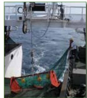
**Figura 3.13.** Beam-trawl (o bou de vara): se trata de un arte de arrastre usado para fondos blandos. Funciona como un “patín” deslizando sobre el fondo, recolectando flora y fauna que queda retenida en la malla y el copo. Es muy eficaz en el muestreo de los organismos que viven sobre el sustrato (epibentos). Las imágenes muestran diferentes momentos de la maniobra de arriado y virada. **Fotos:** IEO/GEMAR.
