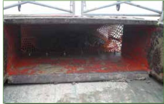
**Figura 3.12.** Draga de arrastre bentónico: funciona como un “patín” deslizando sobre el fondo, recolectando flora y fauna que queda retenida en la malla, la cual está protegida con gruesos cueros. Las imágenes muestran diferentes momentos de la maniobra de arriado y virada. **Fotos:** IEO/GEMAR.
